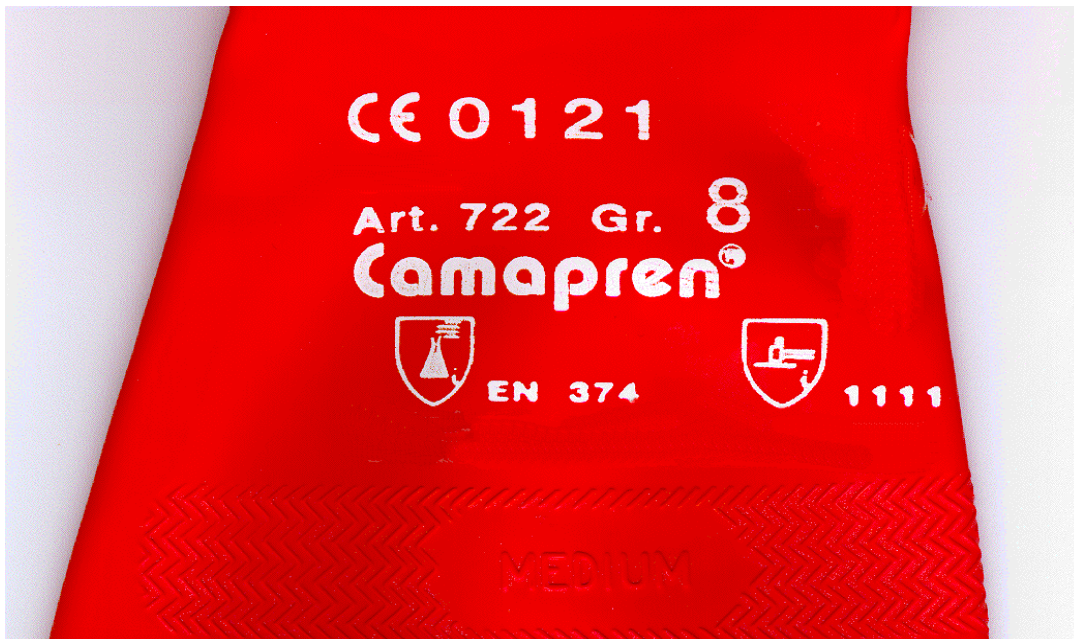
Abbildung 8: Kennzeichnung eines Chemikalienschutzhandschuhs
